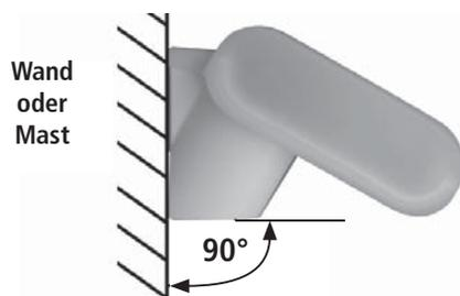
Die Wetterstation muss **in der Querrichtung horizontal** (waagrecht) montiert sein.
