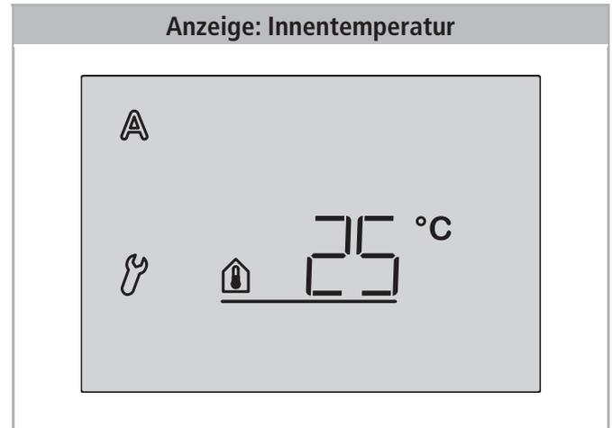
Sobald der hier angegebene Wert überschritten wird, öffnet die Automatik das Fenster (es sei denn, der Sperr-Wert für die Außentemperatur wurde unterschritten, siehe nächster Parameter). Die Verzögerung (Hysterese) beträgt 2°C, d. h. das Fenster wird wieder geschlossen, sobald die Innentemperatur mehr als 2°C unter den eingestellten Wert sinkt.
