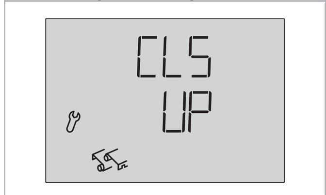
Wurden beim Anschluss des Antriebs die Auf- und Ab-Anschlussleitungen vertauscht, kann dies in diesem Schritt korrigiert werden. Für den Drehrichtungstest öffnen Sie das Fenster zunächst ein Stück weit. Testen Sie beide Pfeiltasten und stellen Sie im Display ein, ob das Fenster mit  $\Delta$  oder mit  $\nabla$  wieder schließt.
