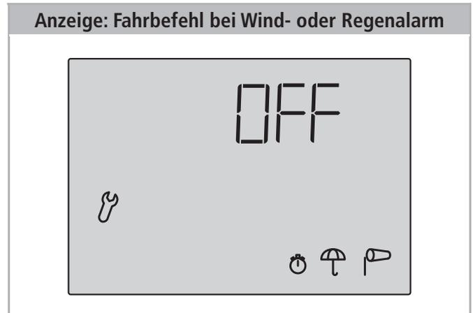
Wird Wind- oder Regenalarm ausgelöst, so wird das Fenster geschlossen. Der Fahrbefehl für den angeschlossenen Antrieb endet entweder nach 4 Minuten oder er wird dauerhaft aufrechterhalten, so lange die Alarmmeldung vorliegt.
