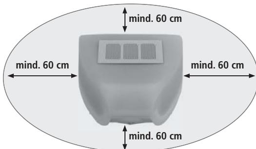
Die Wetterstation muss **an einer senkrechten Wand** (bzw. einem Mast) angebracht werden.
