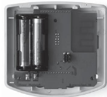
Schließen Sie das Gehäuse wieder, indem Sie die Frontplatte mit Platine von oben in die Rückwand einhängen. Die Verriegelung unten muss mit einem deutlichen „Klick“ einrasten.
