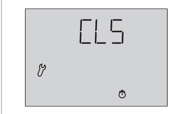
Schließen Sie das Fenster zunächst vollständig. Drücken Sie dann die Taste SET um zum nächsten Schritt zu gelangen.
