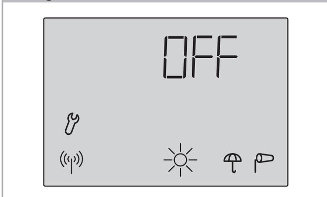
Bitte belassen Sie diese Anzeige auf **OFF**, und verwenden die **FLS 24V** als Ein-Kanal-Steuerung.
