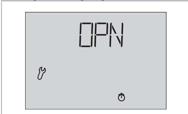
Öffnen Sie nun das Fenster so weit, wie die Automatik dies später tun soll. Drücken Sie dann die Taste SET um zum nächsten Schritt zu gelangen.
