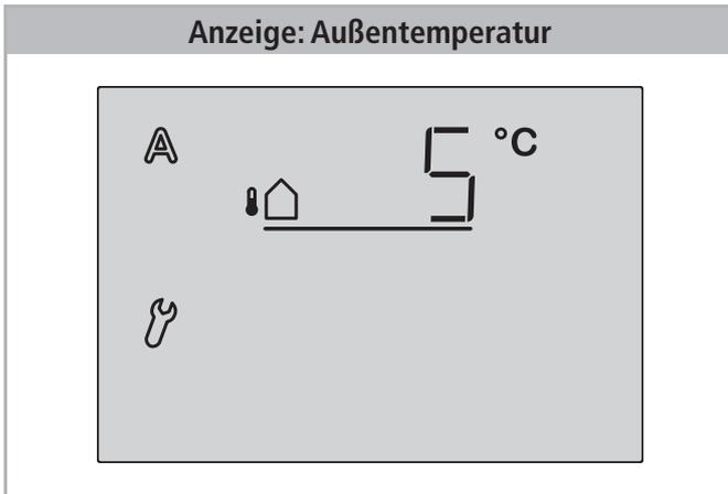
Die Außentemperatursperre hält das Fenster unterhalb der gewählten Temperatur geschlossen. Das heißt, ein geöffnetes Fenster wird im Automatikmodus geschlossen und wird auch nicht mehr geöffnet wenn der Innentemperatur-Werts (Kapitel A) überschritten wird. Dadurch werden Energieverluste beim Lüften vermieden und Pflanzen vor kalter Außenluft geschützt.
