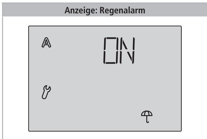
Der Regenalarm schützt Einrichtungsgegenstände vor Beschädigung. Bei Regen wird das Fenster automatisch eingefahren und die manuelle Bedienung ist gesperrt.
