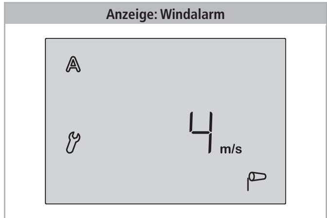
Der Windalarm schützt Fenster und Einrichtungsgegenstände vor Beschädigung. Wird der angegebene Windwert überschritten, schließt das Fenster und die manuelle Bedienung ist gesperrt. Die Windgeschwindigkeit wird in m/s (Metern pro Sekunde) angegeben.
